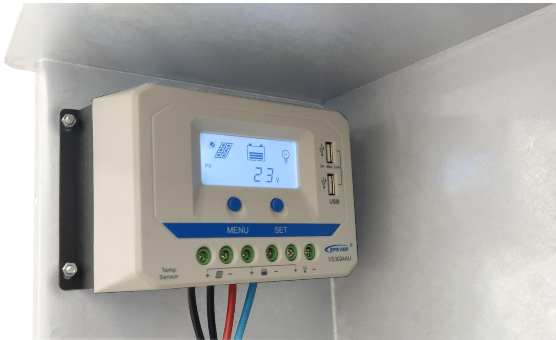
1.12. Подключить провода питания светильника к контроллеру. К разъему «+» красный провод, к разъему «-» синий провод.
