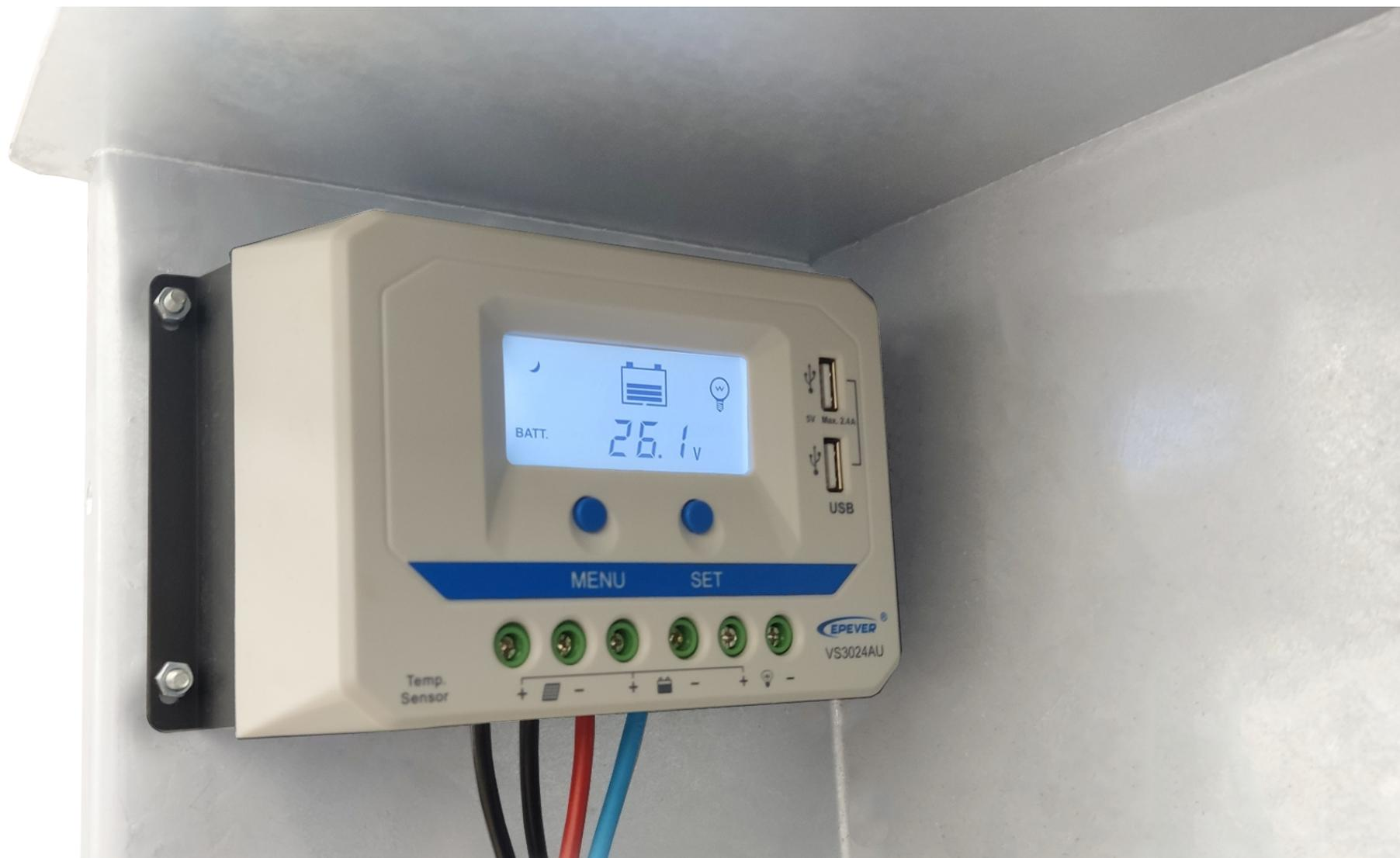
1.11. При правильном подключении соединительных кабелей солнечной электростанции с коробом АКБ, на табло контроллера отобразится символ «СОЛНЕЧНАЯ ПАНЕЛЬ»
