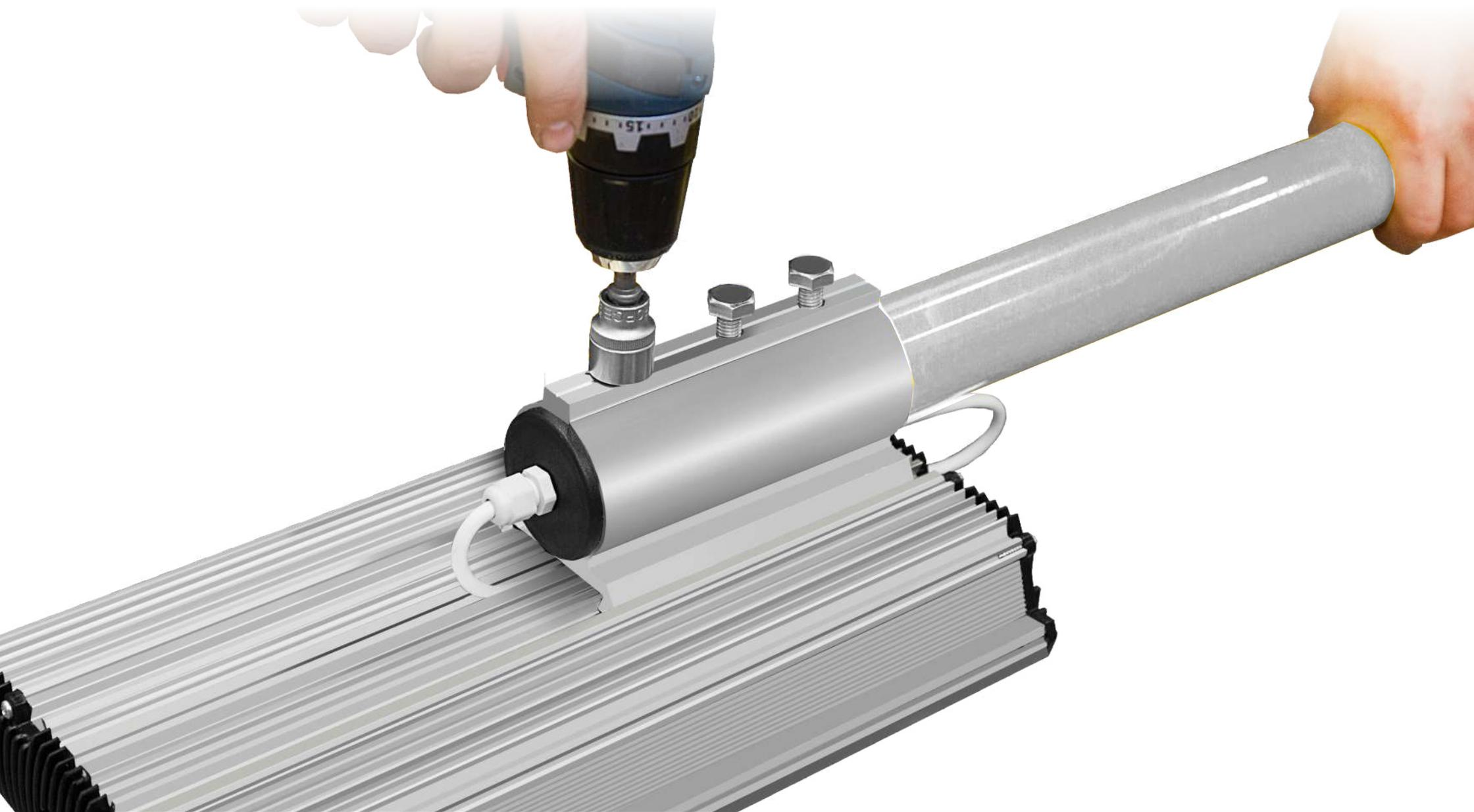
1.3. На опорный столб сверху надеть светильник с кронштейном крепления, отступив от начала столба примерно 50 см. Зафиксировать светильник на столбе зажимными болтами.
